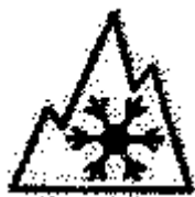
Рис. 4.1. Маркировка, наносимая на зимнюю шину
